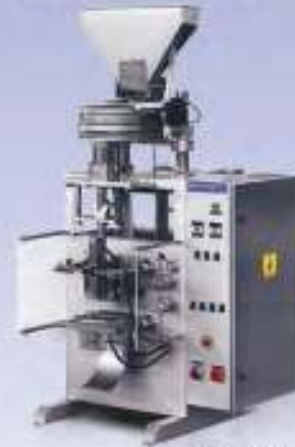
دستگاه بسته بندی حجمی جهت بسته بندی مواد گرانولی از قبیل تخمه، بسته برنج، حبوبات، پفک، پودر شوینده، شکر و ...
