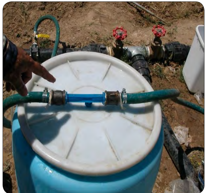
شکل ۳- استفاده از شیر ونتوری برای تزریق کود
