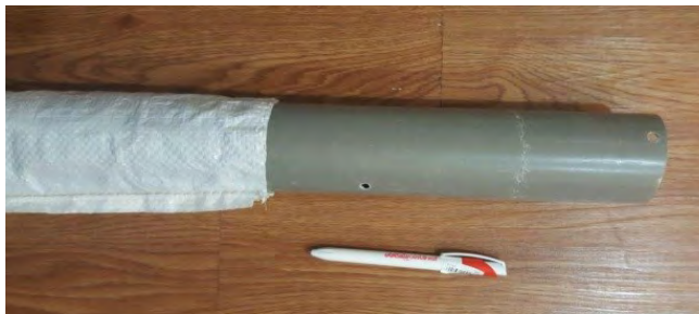
شکل ۱ تصویر نمونه لوله تراوا و پوشش پارچه پلاستیکی اطراف آن
