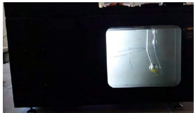
شکل ۳. دستگاه اندازه‌گیری ویسکوزیته روغن‌های معدنی
