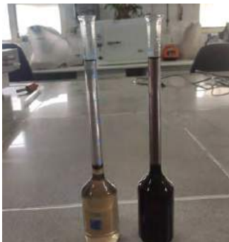
شکل ۶. تعیین درجه سولفوناسیون روغن‌های معدنی
