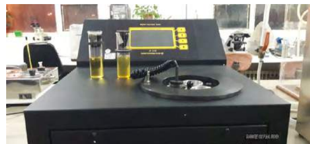
شکل ۴. دستگاه اندازه‌گیری نقطه ریزش روغن‌های معدنی
