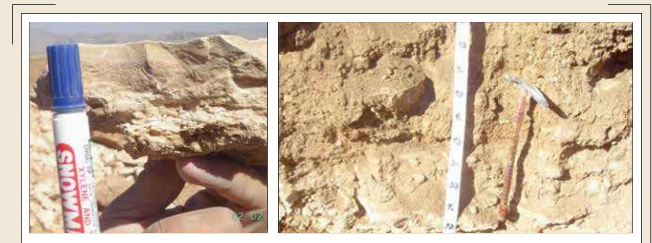
شکل ۵- نمونه‌ای از لایه سخت در پروفیل خاک (لایه سخت آهکی یا پتروکلسیک)
