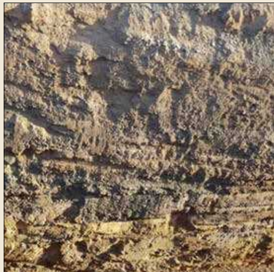
شکل ۴- محدودیت لایه‌بندی شدید و وجود سنگریزه زیاد در پروفیل خاک
