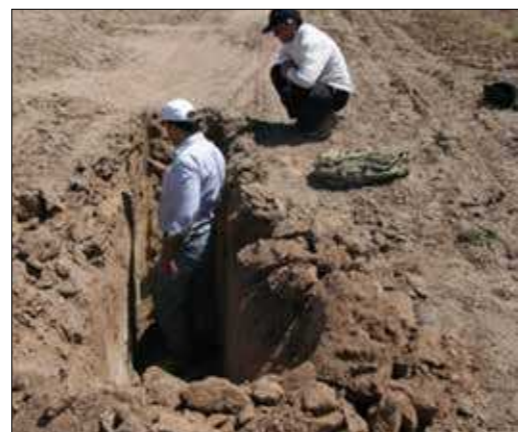
▲ شکل ۱- پروفیل حفر شده در اراضی بکر جهت شناسایی خاک
